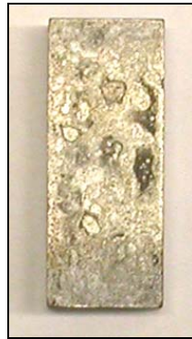
Figure 2.29 : Détail de surface d'une barre de matériau fer-diélectrique après recuit à 450 °C
