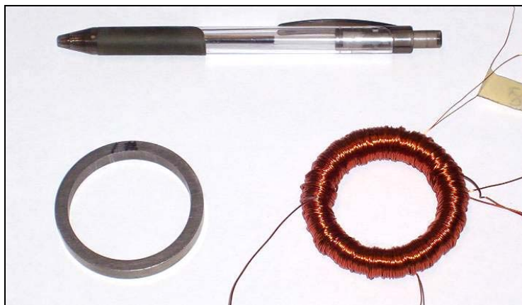
Figure 2.3 : Anneau de caractérisation pressé (à gauche) et après bobinage (à droite)
