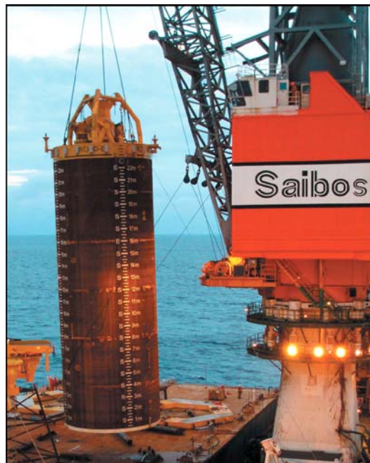
Figure I-8 Caisson à succion (Colliat et al, 2007)
