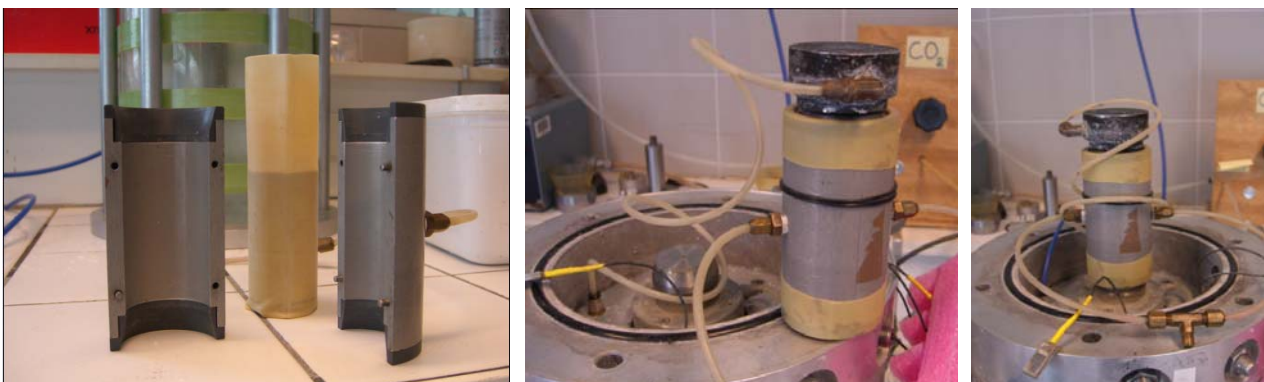
Figure V-23 Montage de l'éprouvette sur la cellule avec la moule
