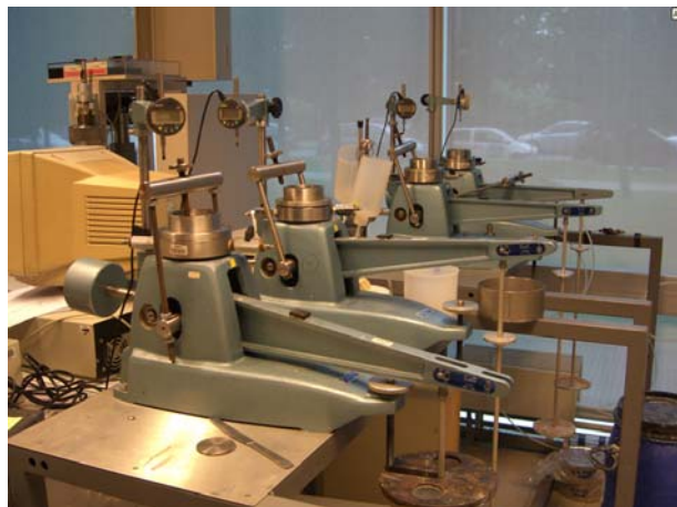
Figure IV-12. Dispositif d'expérimental : l'oedomètre (CERMES/ENPC)
