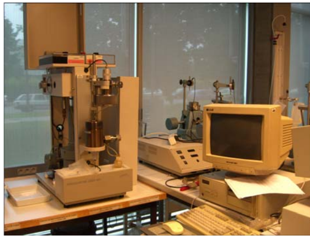
Figure II-34 Dispositif expérimental: Porosimètre à mercure FISONS 2000
