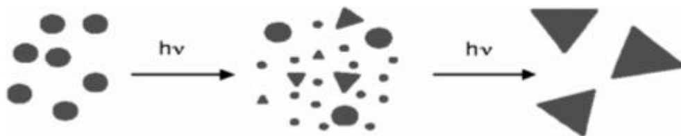
FIG. II.15 – Principe d’obtention des nanoprismes de platine à partir de la modification des nanosphères par irradiation
