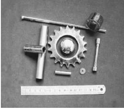
Figure I.8-a : Plusieurs formes d'un alliage amorphe Vitreloy ou Vit1 ( Zr_{41}Ti_{14}Cu_{12.5}Ni_{10}Be_{22.5} ) obtenues par différentes techniques de trempe.
