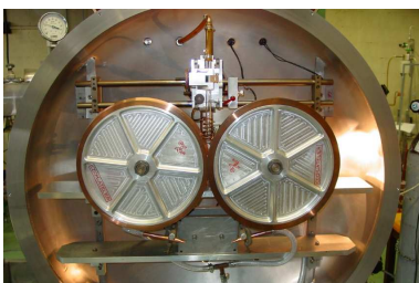
Figure II.4-a : Hypertrempe entre rouleaux (CECM / Vitry)
