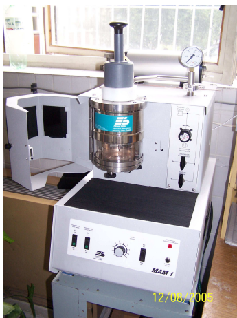
Figure II.1-a : Four à arc (Physic Ustav / Bratislava, Slovaquie)
