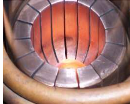
Figure II.2-b: Creuset en cuivre avec spires magnétiques
