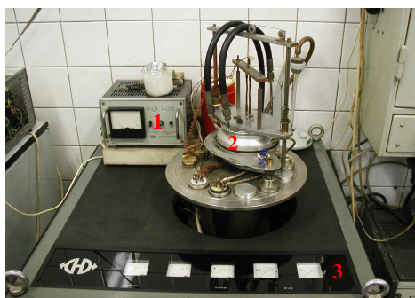
Figure II.8-a : Appareil d'un résistomètre quatre points. (1) Suivi du courant, (2) Système de chauffage dans lequel on glisse le ruban. Au dessus de cette partie est placée une chambre dans laquelle on établit un vide secondaire, (3) Mesure du vide.
