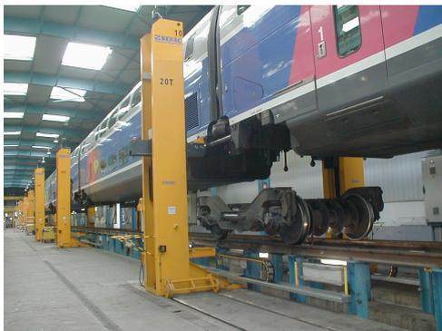
FIG. C.1 – Levage d'une rame TGV lors du remplacement des bogies
