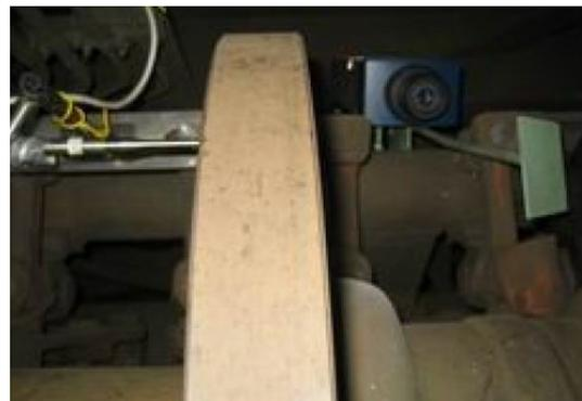
FIG. 7.11 – Implantation du vibromètre laser embarqué
