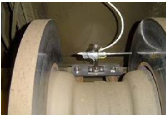
FIG. 7.10 – Implantation du microphone embarqué
