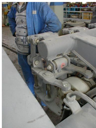
FIG. C.7 – Système d'application de l'effort de freinage
