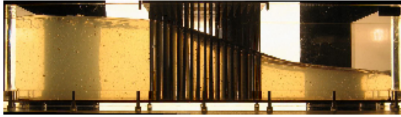
Figure 6.3: Forme à l'arrêt d'un écoulement d'une suspension de Carbopol de 22 Pa passant par une zone très ferrillée désignée C e19z8
