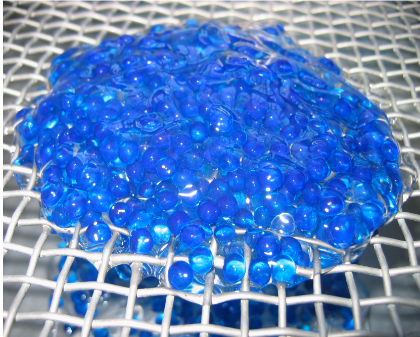
Figure 7.5: Résidu d'un mélange granulaire de billes 5 \text{ mm} à concentration en solide \phi = 30\% sur tamis d'ouverture 6,3 \text{ mm}
