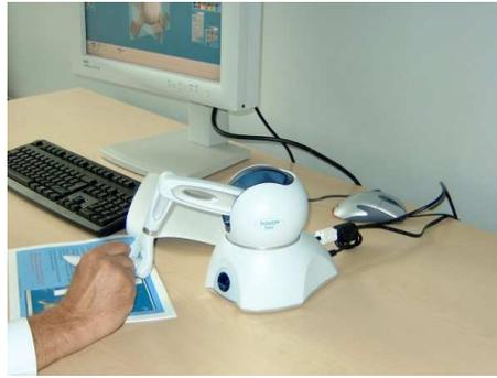
FIG. 3.4 – *Dispositif non-immersif : un phantom*
