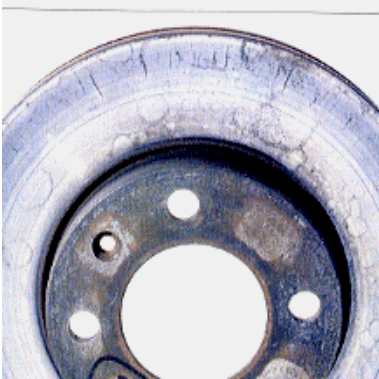
FIG. 1.9: Faiençage sur les pistes de frottement
