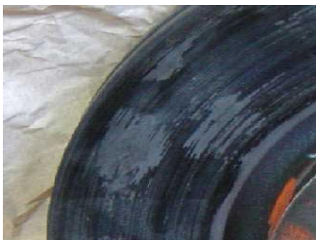
FIG. 1.17: Dépôts de matière sur les pistes du disque
