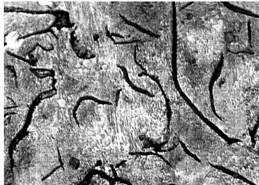
FIG. 3.1: Fonte GLJ2 à graphite lamellaire
