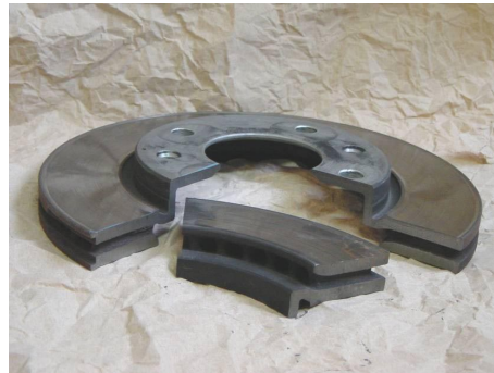
FIG. 1.6: Exemple de disque ventilé
