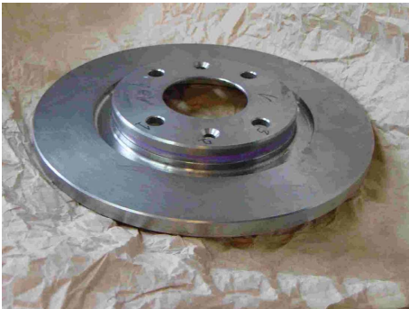
FIG. 1.5: Exemple de disque plein
