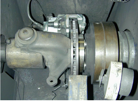
FIG. 3.22: Disque à l'intérieur de l'enceinte
