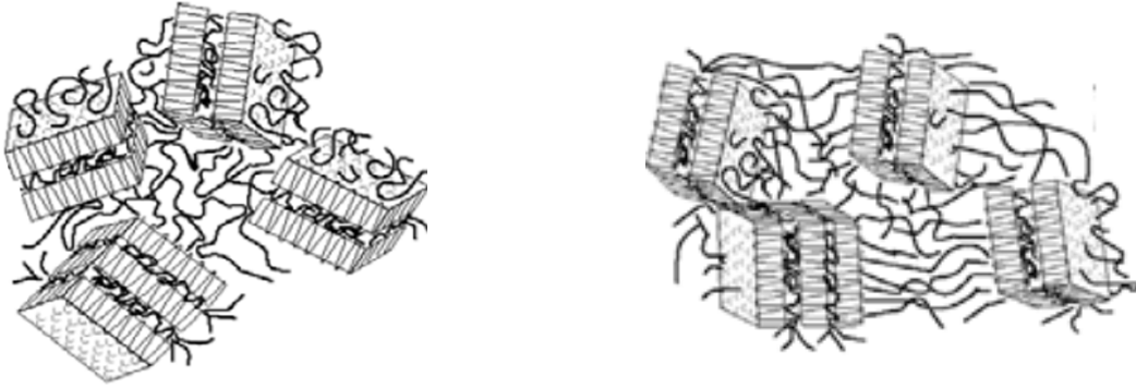
FIGURE 1.17 – Impact de la déformation (ici horizontale) sur l'orientation des cristallites.
