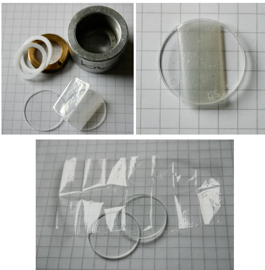
FIGURE 2.11 – Cellule de mesure pour la diffusion de neutrons aux petits angles. La membrane étudiée est pliée en 16 épaisseurs placées entre deux disques de quartz. La surface éclairée est de l'ordre du \text{cm}^2 et l'épaisseur totale 16 \times 9 \mu\text{m} = 144 \mu\text{m} .
