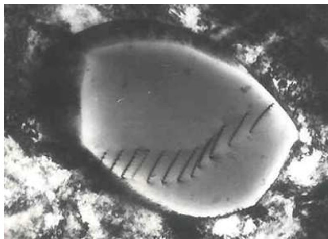
FIG. 1.1 – Les dislocations dans l'acier inoxydable.
