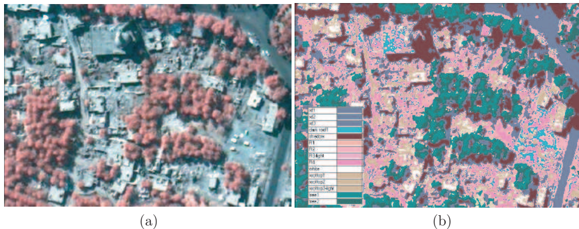
FIG. 2.29 – Classification par analyse de texture à l'aide des demi-variogrammes à partir des bandes multispectrales [Saito et Spence, 2004] sur la ville de Bam. (a) Image de crise utilisée pour la classification – (b) Résultat de la classification des pixels. Parmi des classes définies, les pixels classés comme débris sont en couleur saumon à rose (4 classes distinctes) : ils sont très présents dans toute l'image, correspondant à de réels dégâts ou non.
