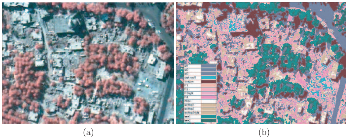
FIG. 2.29 – Classification par analyse de texture à l'aide des demi-variogrammes à partir des bandes multispectrales [Saito et Spence, 2004] sur la ville de Bam. (a) Image de crise utilisée pour la classification – (b) Résultat de la classification des pixels. Parmi des classes définies, les pixels classés comme débris sont en couleur saumon à rose (4 classes distinctes) : ils sont très présents dans toute l'image, correspondant à de réels dégâts ou non.
