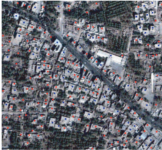
FIG. 2.32 – Résultats de la détection de dégâts à partir d’une classification de la scène et d’un SIG pour la ville de Bam pointant l’emplacement des bâtiments de la ville avant la catastrophe. En bleu sont représentés les bâtiments détectés intacts ou partiellement détruits; et en rouge les bâtiments très endommagés, chacun correspondant, à la suite du séisme, à un ensemble de pixels (segment de l’image) associés majoritairement à une classe différente de “bâti” par classification ISODATA.
