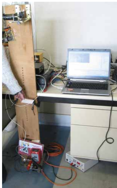
Figure 3.8 : Tester les encodeurs avec un mètre laser.
