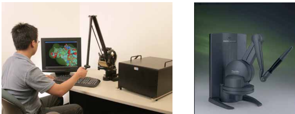
Figure 1.7 : PHANToM Desktop avec 3 ddl (droit) et 6 ddl actifs (gauche).
