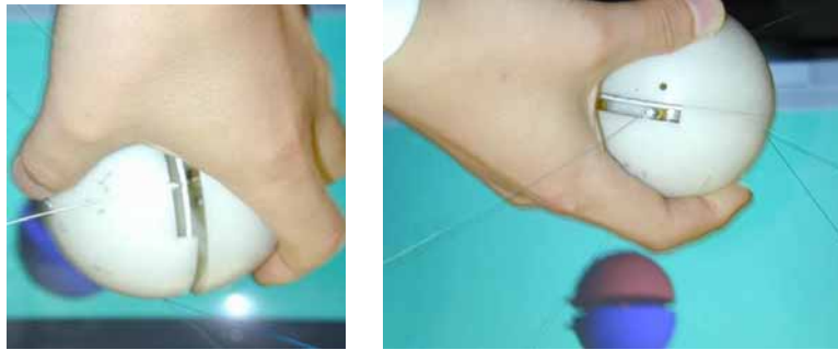
Figure 1.33 : Etat de l'effecteur final de SPIDAR-G avant (gauche) et après (droit) la préhension.
