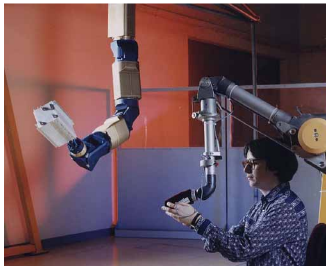
Figure 1.6 : Système maître esclave pour la téléopération.
