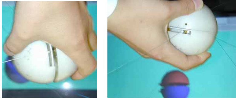
Figure 1.33 : Etat de l'effecteur final de SPIDAR-G avant (gauche) et après (droit) la préhension.
