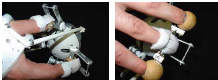
Figure 4.7 : L'indépendance des doigtiers malgré le mouvement simultané.
