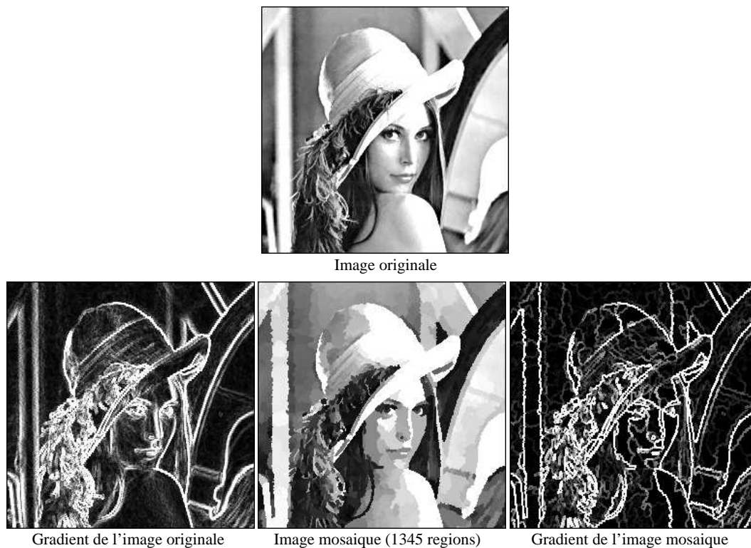
Figure 5.18: Exemple "Lena" : Sur-segmentation, image mosaïque et gradient
