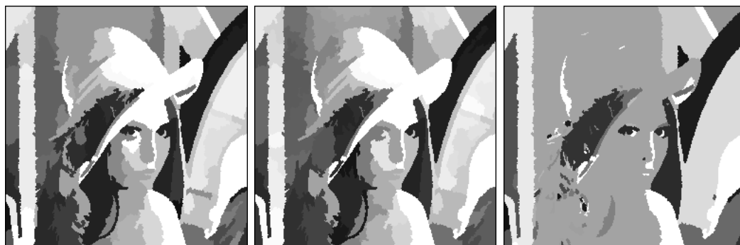
Figure 5.19: Exemple “Lena” : segmentation des 100 régions les plus significatives en termes de volume (à gauche), de surface (au centre), de dynamique (à droite). Les valeurs d'extinction ont été calculées sur le gradient de l'image mosaïque.
