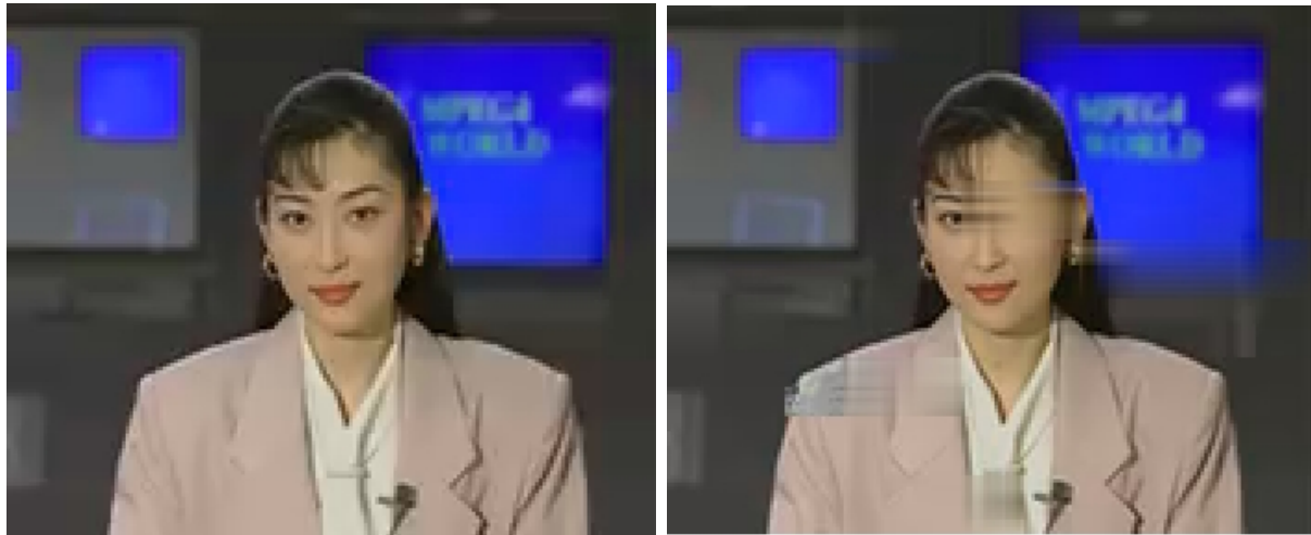
FIGURE 4.15 – Exemples de résultats visuels obtenus avec la simulation : à gauche, avec adaptation, et à droite sans adaptation du canal.
