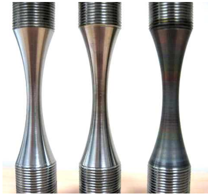
Fig. 97 – Epreuves de traction en Ti-6Al-4V (respectivement Ti, Tiul, TiT).
