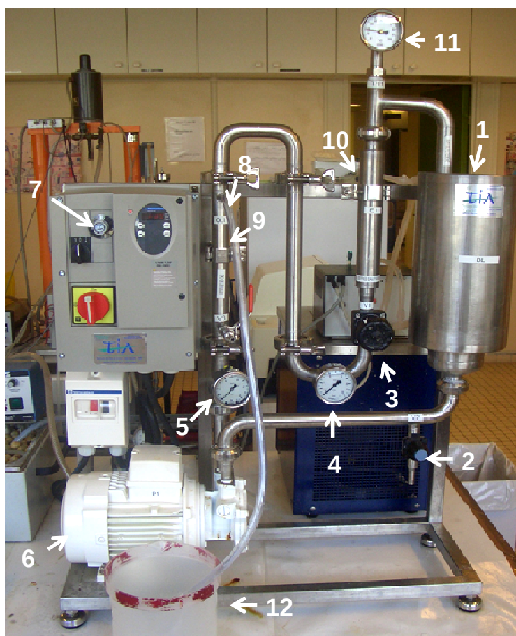
Figure II.5 : module de microfiltration tangentielle utilisé pour la concentration de Lb. bulgaricus CFL1
