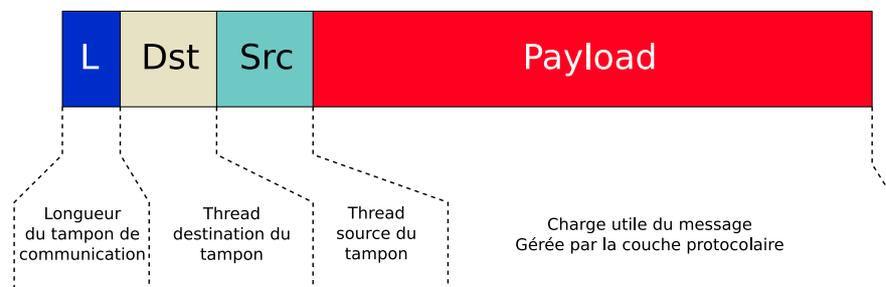
FIGURE 5.4 – Structure d'un tampon de communication
