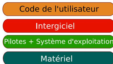
FIGURE 2.2 – Emplacement de la couche intergicielle
