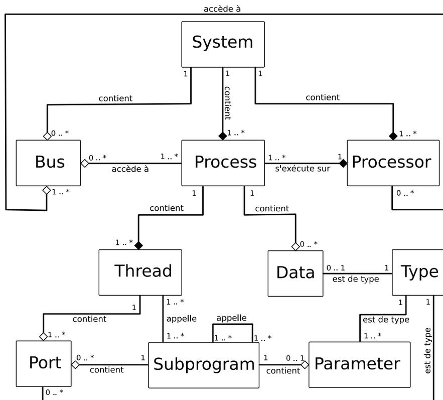
FIGURE 5.3 – Architecture générique d'une application
