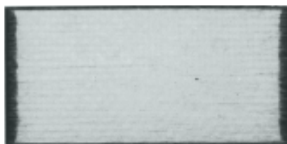
Figure 2 : Mise en évidence par radiographie X de la fissuration (zone sombre) sur les bords d'un composite unidirectionnel carbone/époxyde (T800H/6379) après 4000 heures d'exposition dans l'air à 180°C [22].
