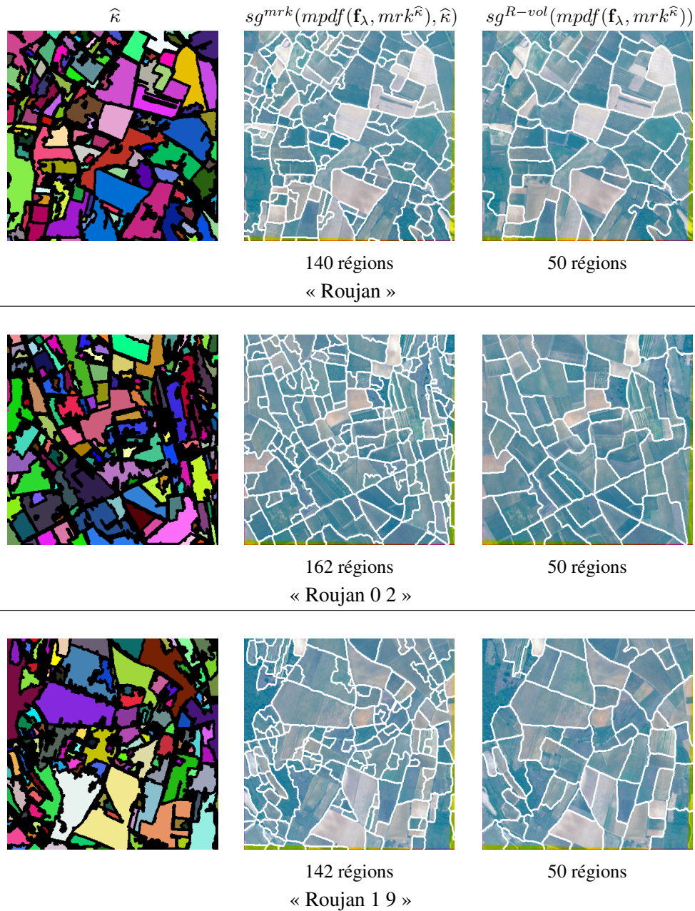
FIG. 3.43 – Comparaison entre les segmentations de mpdf(\mathbf{f}_\lambda, mrk^{\hat{\kappa}-Ub-connex}) par LPE probabiliste contrôlée par marqueurs issus de la classification sg^{mrk}(mpdf(\mathbf{f}_\lambda, mrk^{\hat{\kappa}}), \hat{\kappa}) ou par LPE probabiliste avec un nombre de régions, R = 50 , défini a priori sg^{R-vol}(mpdf(\mathbf{f}_\lambda, mrk^{\hat{\kappa}})) . Les résultats sont présentés sur les images : « Roujan », « Roujan 0 2 », « Roujan 1 9 ».
