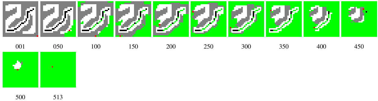
FIG. 4.23 – Quelques images du remplissage (pixels verts) de l'image « lacets » pour différents points sources (en rouge) par la méthode des extrema géodésiques.
