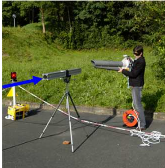
Figure 6.22 : Génération « artisanale » de rafale de vent dans un tube pour une expérience de détection
