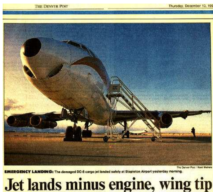
Figure 1.4 : En 1992, un cargo parvient à atterrir après avoir perdu un réacteur et un morceau d'aile sous l'effet d'une turbulence extrême
