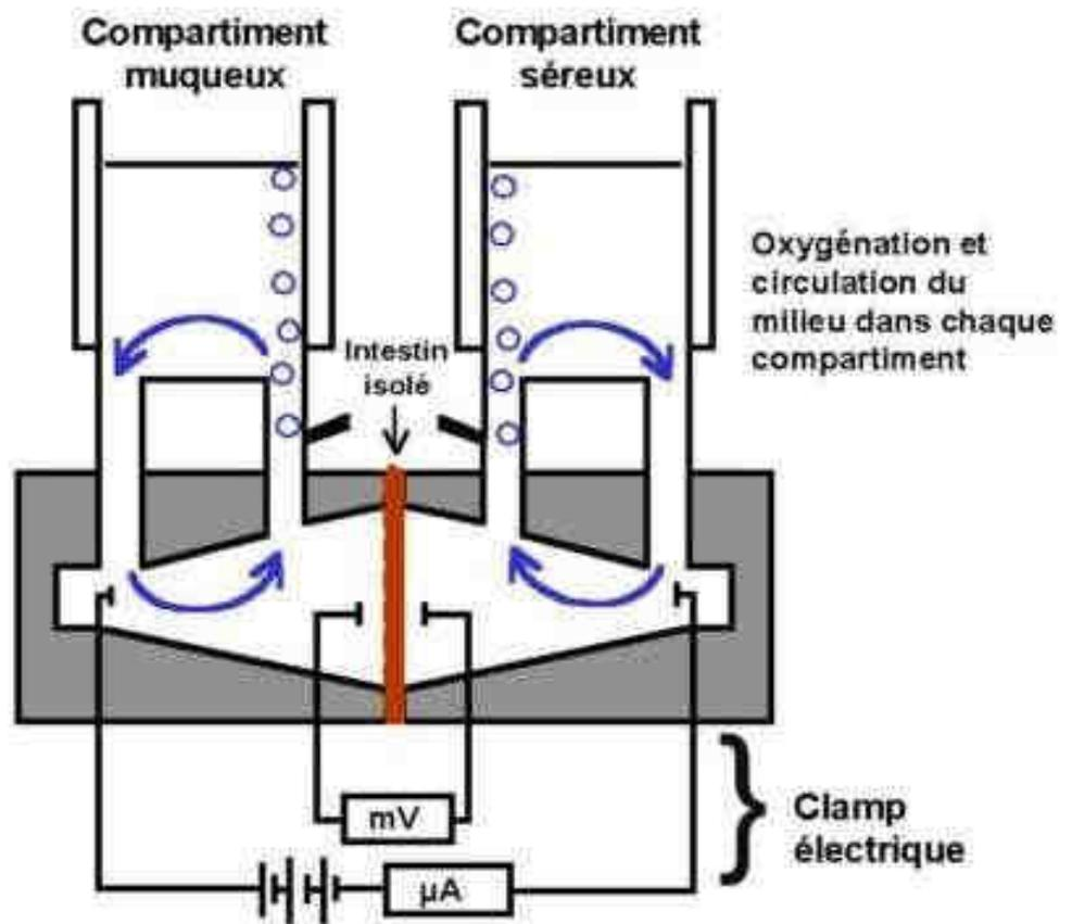
**Figure 10 :** Représentation schématique de la chambre de Ussing
