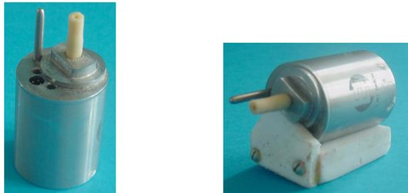
Figure 24 : Capteur autonome de pression et température (NanoVACQ NVQ/PT-TC  $\varnothing = 3,5$  cm, L = 3,5cm)
