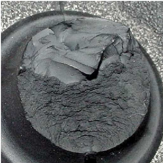
FIGURE 9.11 – Faciès de rupture d'AE2 à 100°C (NR), faible durée de vie.
