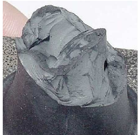
FIGURE 9.12 – Faciès de rupture d'AE2 à 100°C (NR), grande durée de vie.
