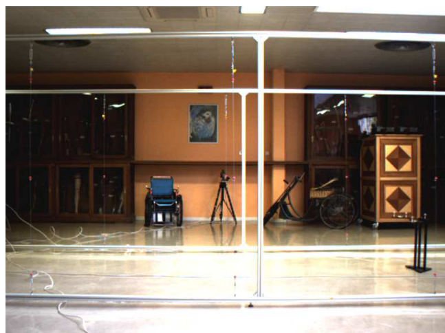
Figure 36 : Exemple de distorsion « en barillet »
