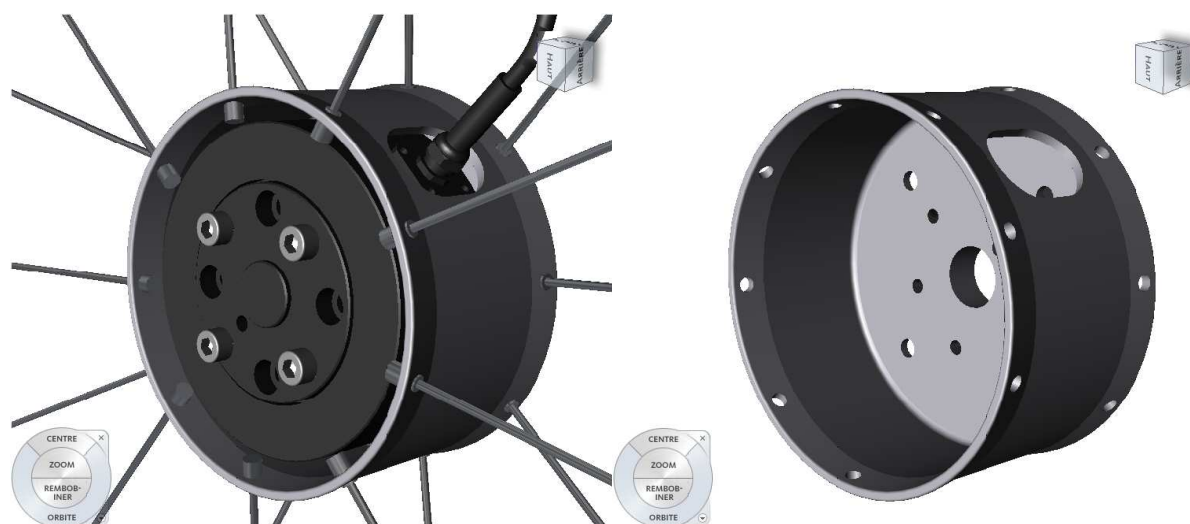
Figure 55 : Images CAO de la pièce d'adaptation d'un capteur six composantes de roue
