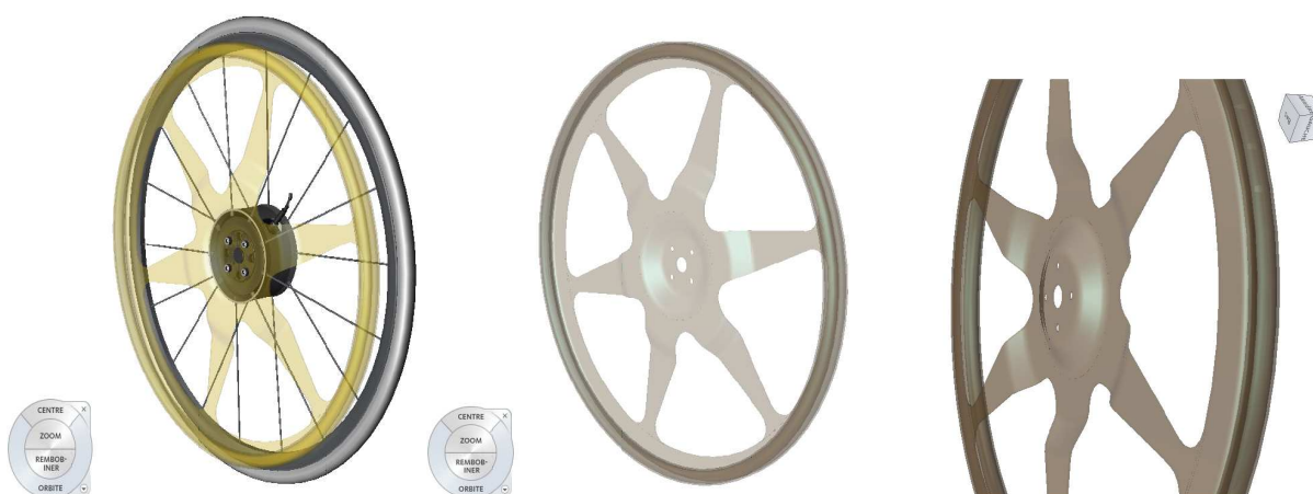
Figure 56 : Images CAO de la pièce liaison capteur et main-courante
