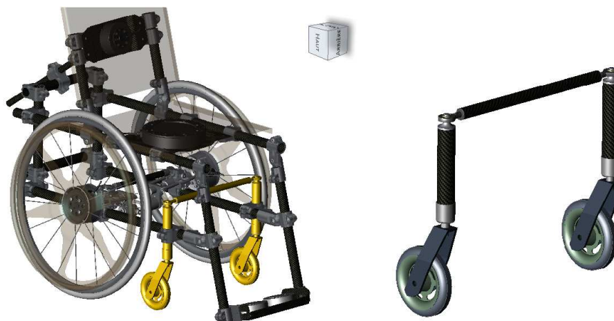
Figure 60 : Images CAO des adaptations roues directrices
