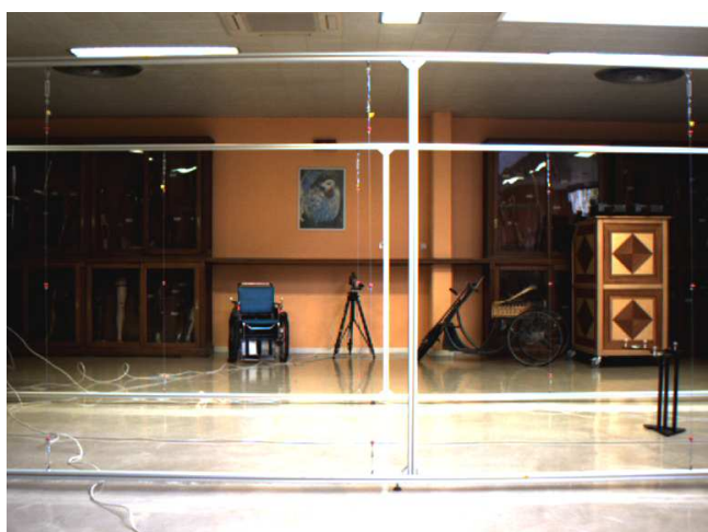
Figure 36 : Exemple de distorsion « en barillet »
