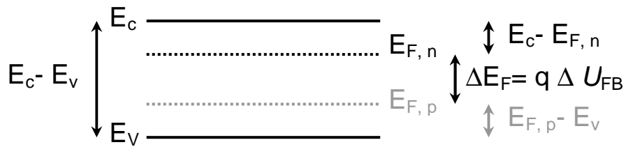
Figure 1.13 : Diagramme de bandes du silicium.
