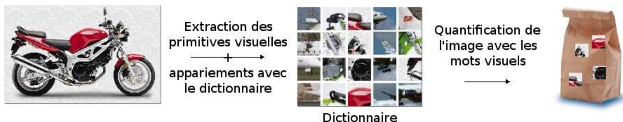
FIG. 1.24: Représentation d'une image selon le paradigme des sacs de mots visuels. Les primitives extraites dans l'image courante sont mises en correspondance avec les mots du dictionnaire pour décrire l'image en fonction de l'occurrence de ces mots.
