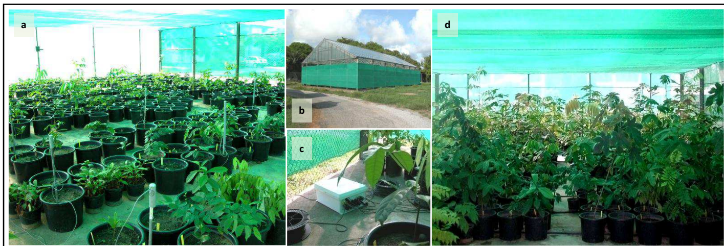
Figure 8. Photographies du dispositif expérimental. a. Mesure de l'éclairement relatif à l'aide de capteurs instantanés de PAR (Rayonnement Photosynthétiquement Actif) placés au-dessus des plants et reliés à (c) une centrale d'acquisition des données (novembre 2003). b. vue extérieure de la serre. d. vue intérieure de la serre (septembre 2004).
