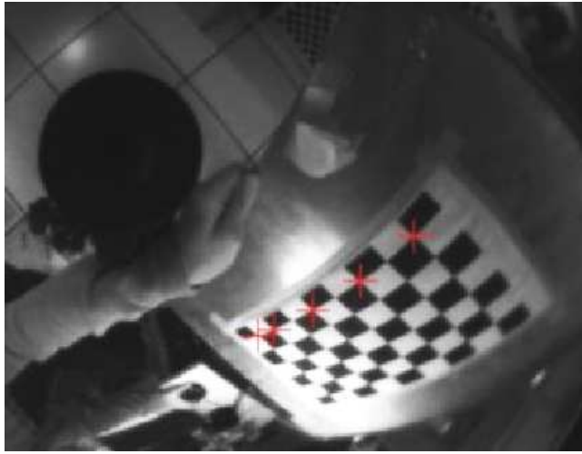
Figure 9: Estimation de la distance focale généralisée grâce à des points alignés dans la scène
