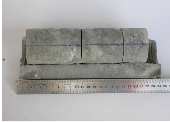
Figure 3-46 : Vue de la carotte EST12491 après démontage de la cellule de confinement.
