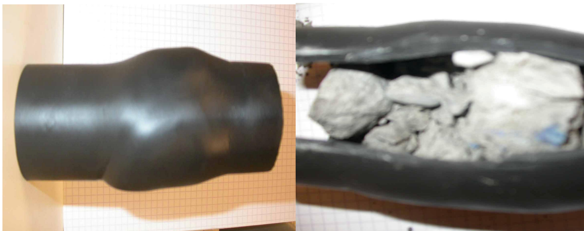
Figure 4-39 : Vues l'éprouvette N°1 après rupture.
