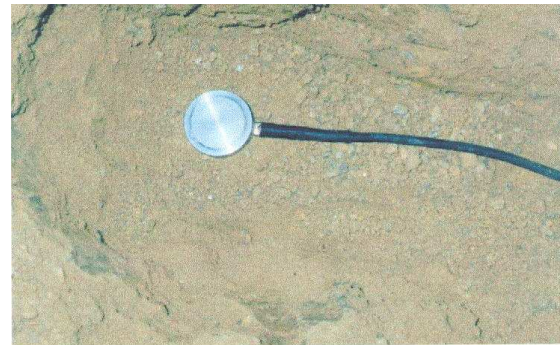
d) Capteur de pression totale
