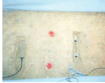
d) TDR, tensiomètre et sonde de température en place
