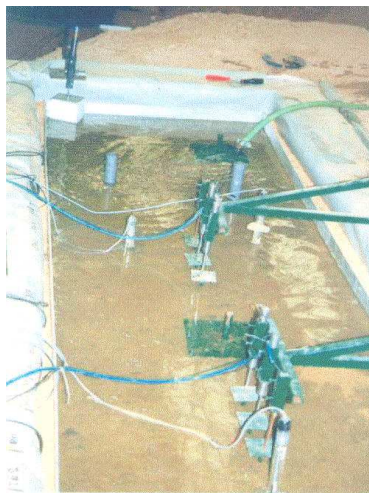
Figure 3.9. Humidification du remblai R1
