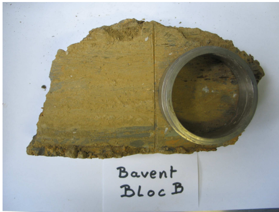
(a) Découpage des échantillons de taille proche de celle de la bague
