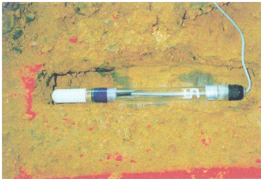
c) Tensiomètre pour mesurer la pression interstitielle
