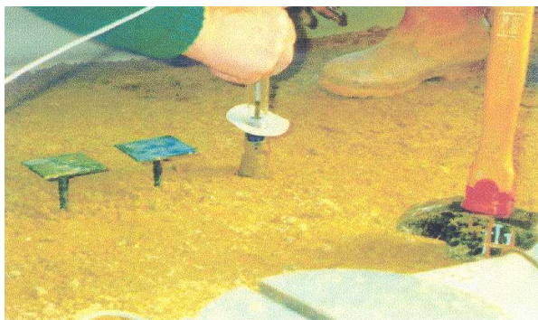
a) Mise en place des tassomètres
