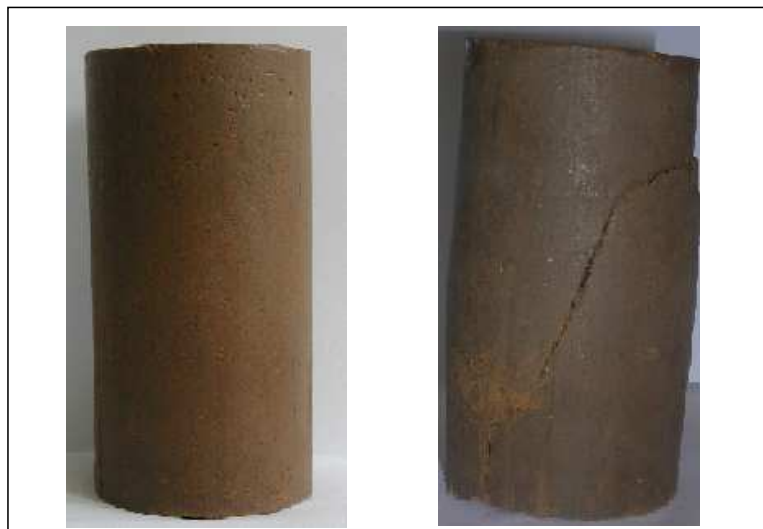
Figure 6.9. Éprouvette triaxiale avant et après l'essai (limon SNEC, \sigma_3 = 63 kPa et s = 30 kPa)
