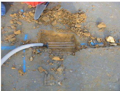
a) mise en place de la sonde TDR
