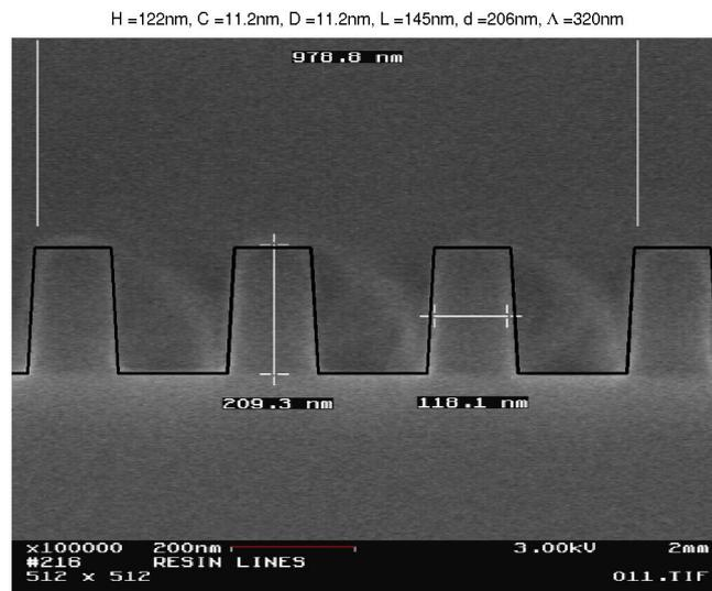
FIGURE 6.28 – Image MEB du réseau (140/320). Ligne noire : profil ajusté avec un modèle trapézoïdal.
