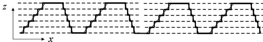
FIGURE 6.13 – Découpage d’un réseau unidimensionnel invariant suivant  $y$  en une superposition de réseaux lamellaires.
