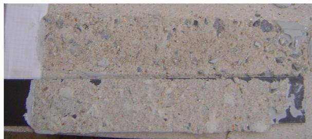
FIG. 3.6: Photo d'un échantillon après rupture
