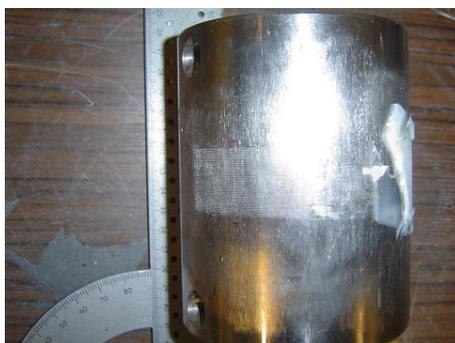
FIG. 6.25: Photo d'une zone de frottement après essai permettant de vérifier que celui-ci a bien eu lieu
