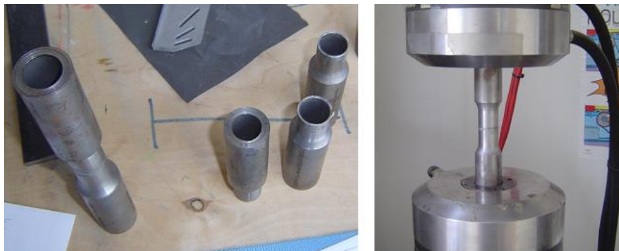
FIG. 5.15: Photos des éprouvettes de torsion/traction à gauche et d'une éprouvette mise en place dans la machine d'essai à droite
