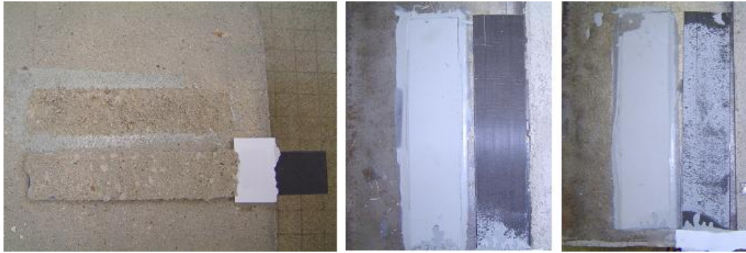
FIG. 3.9: Photos des modes de rupture observés, de gauche à droite : cohésive dans le béton, à l'interface colle-renfort, cohésive dans la colle
