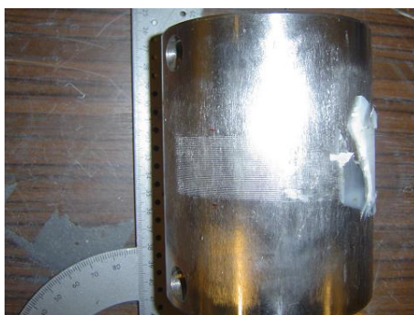
FIG. 6.25: Photo d'une zone de frottement après essai permettant de vérifier que celui-ci a bien eu lieu
