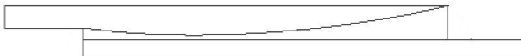
FIG. 5.2: Schéma d'un joint optimisé selon la méthode développée dans Hadj-Ahmed et al. (2001b)
