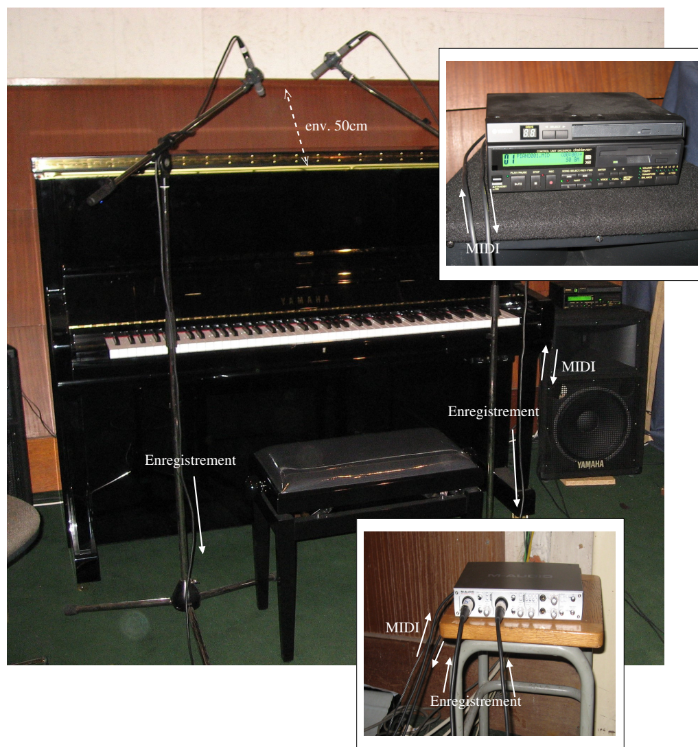
FIGURE 6.7 – Dispositif d'enregistrement : la carte son (en bas à droite) envoie les fichiers MIDI vers le boîtier du piano (en haut à droite), reçoit les notes jouées via une liaison MIDI inverse et enregistre le son produit (les micros sont ici placés près du piano).
