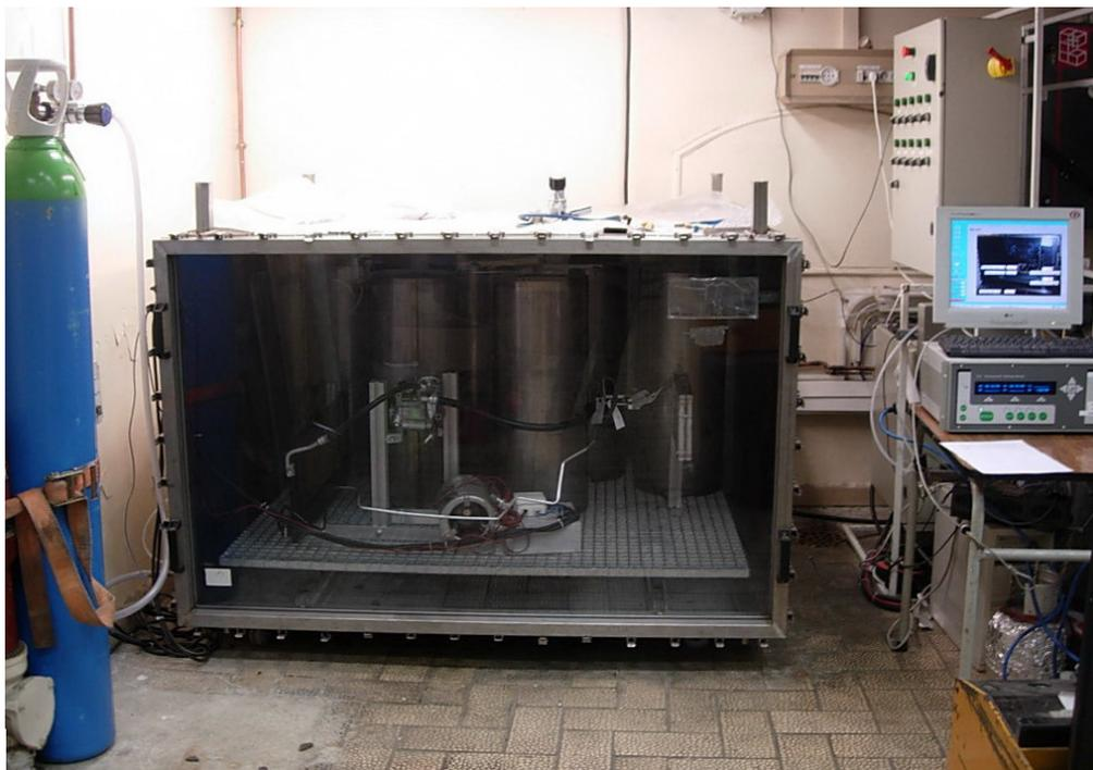
Figure 2.3 Banc d'essais pour l'étude des systèmes de climatisation automobile
