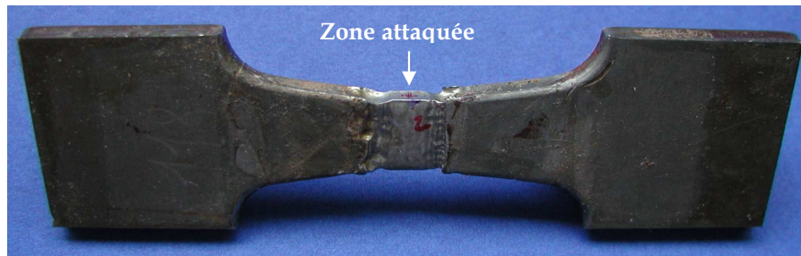
Figure III.13 – Éprouvette après polissage électrolytique
