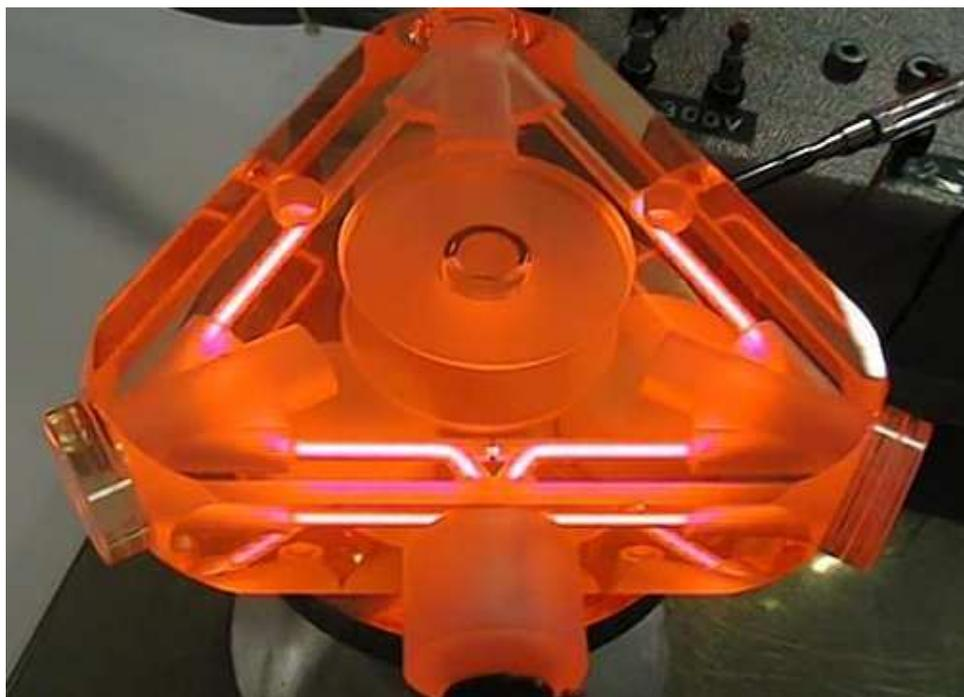
FIGURE 1.5 – Exemple d'un gyrolaser Hélium-Néon (Thales division Aerospace).
