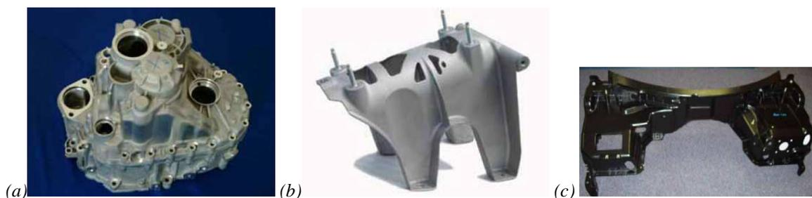
Figure 1.3: Utilisation des alliages de magnésium dans l'industrie automobile [REI.04] : (a) Boîte fixe d'embrayage en AZ91D (VW AUDI). (b) Socle pour bras de changement de vitesse en AM60 (SaturnVue). (c) Devant de tableau de bord en AM60 (DaimlerChrysler)
