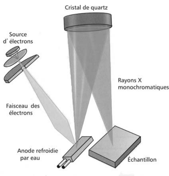
Figure 2.14: Représentation schématique du fonctionnement d'un monochromateur de rayons X (d'après John F. Watts, 2003).
