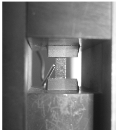
Figure 19 : Montage de compression
