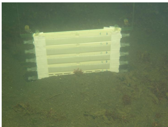
Figure A.1.2. Dialyseurs à loges introduits dans les sédiments marins.
