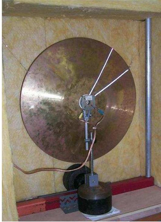
FIGURE 5.1 – Photo de la coque 3 attachée par des fils de Nylon à son bâti.
