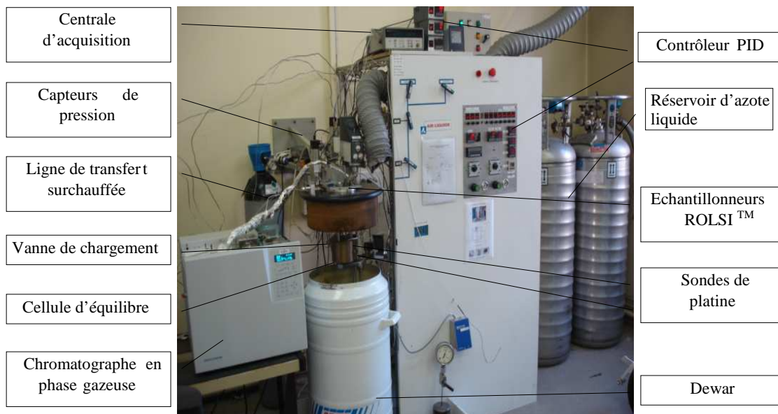
Figure 30 : Photographie de l'équipement cryogénique
