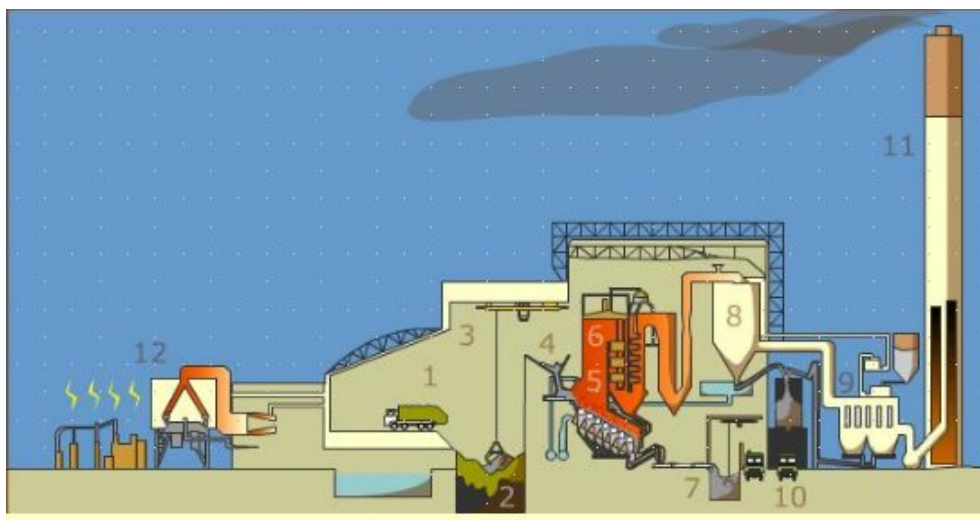
FIG. 2.2 – Principe de fonctionnement d’une UIOM : (1) Admission des OM ; (2) Fosse de stockage (homogénéisation) ; (3) Grue de déchargement ; (4) Trémie d’alimentation ; (5) Chambre de combustion ; (6) Chaudière (récupération d’énergie) ; (7) Production de MIOM ; (8) Traitements des fumées ; (9) Dépoussiérage ; (10) Production de REFIOM ; (11) Evacuation des gaz par des cheminées ; (12) Turbines à vapeur (source : www.france-incineration.org ).
