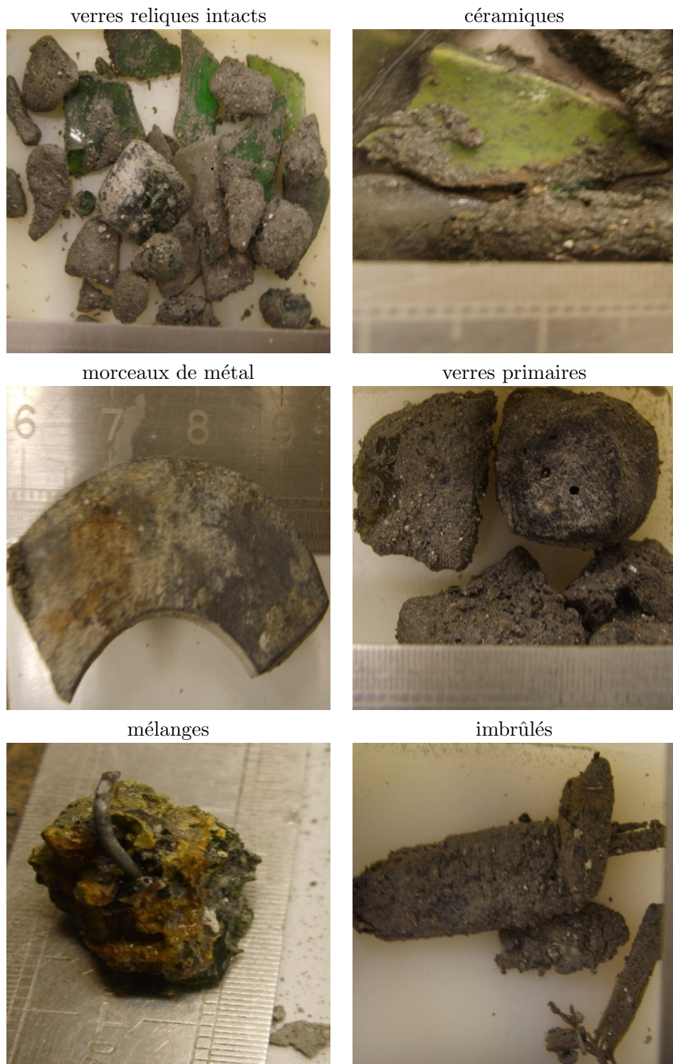
FIG. 3.5 – Différents éléments identifiés lors de l’observation macroscopique du MIOM. Les “verres primaires” ont plus particulièrement fait l’objet d’une caractérisation fine.
