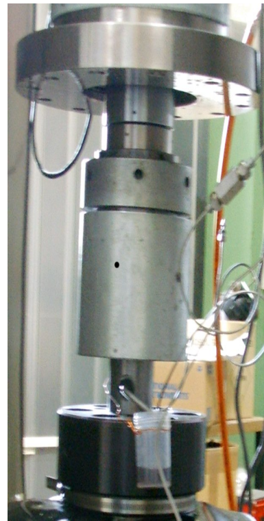
FIG. B.1 – Représentation schématique de la cellule de compression et photographie de celle-ci en phase de compression.
