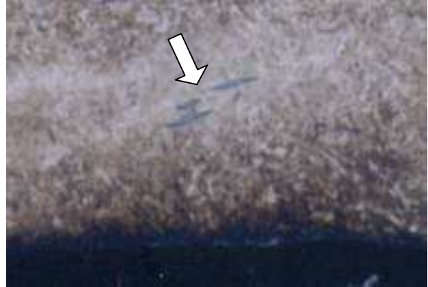
Figure I.8 : Exemple de sulfures à proximité de la surface du rayon après ébauche et TSI (x 100)
