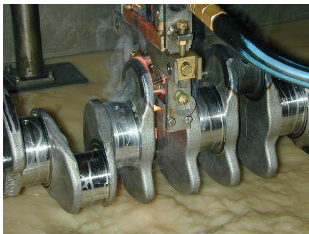
Figure I.16 : Chauffage du maneton 3, inducteur en position PMH
