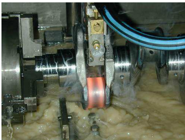
Figure I.15 : Fin de chauffage du maneton 1, remontée de l'inducteur
