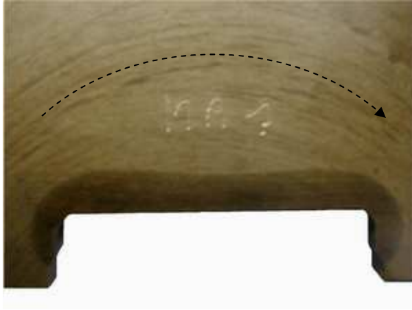
Figure I.7 : Fibrage de l'acier sur une coupe de maneton
